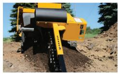
**HOHER DREHMOMENT.** Die RTX130 ist mit einem 10 kW (13 PS) Honda Motor für optimale Leistung beim Fräsen ausgestattet.
