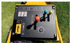
VERBESSERTE STEUERUNG. Mit nur geringem Kraftaufwand lässt sich die Hebelsteuerung der RTX130 gegenüber traditionellen Lenkungen spielend leicht manövrieren und bietet dadurch selbst bei schwierigen Bodenverhältnissen volle Kontrolle.
