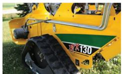
**RAUPENSYSTEM.** Das optionale Raupenfahrwerk gewährleistet zusätzliche Traktion und Stabilität beim Fräsen.
